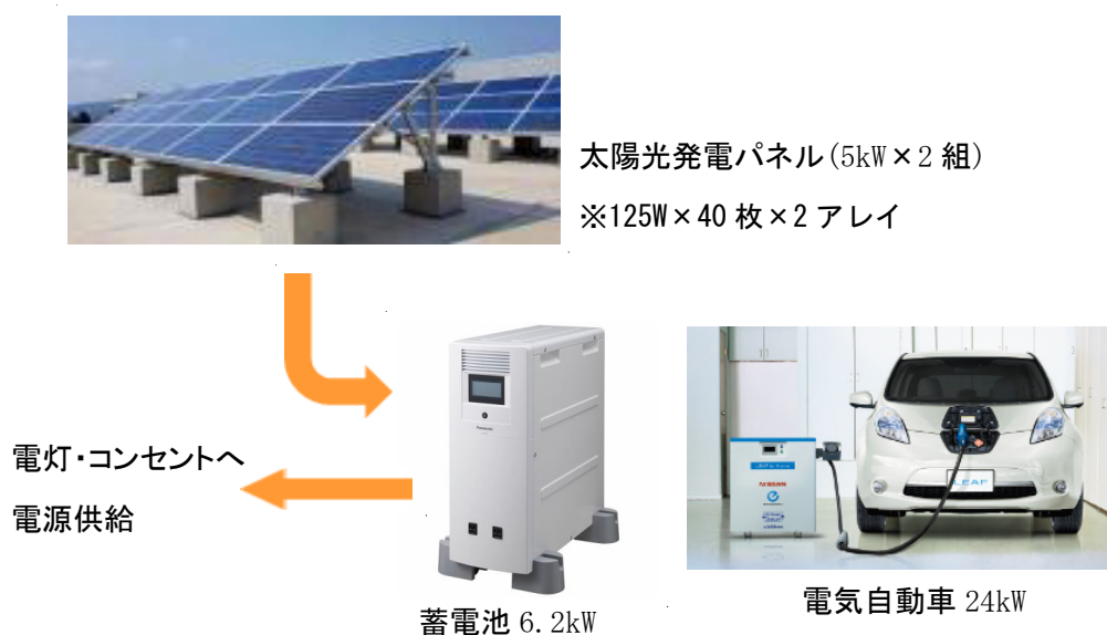
図 5.33 導入技術の概要（太陽光発電+蓄電池システム+電気自動車）
