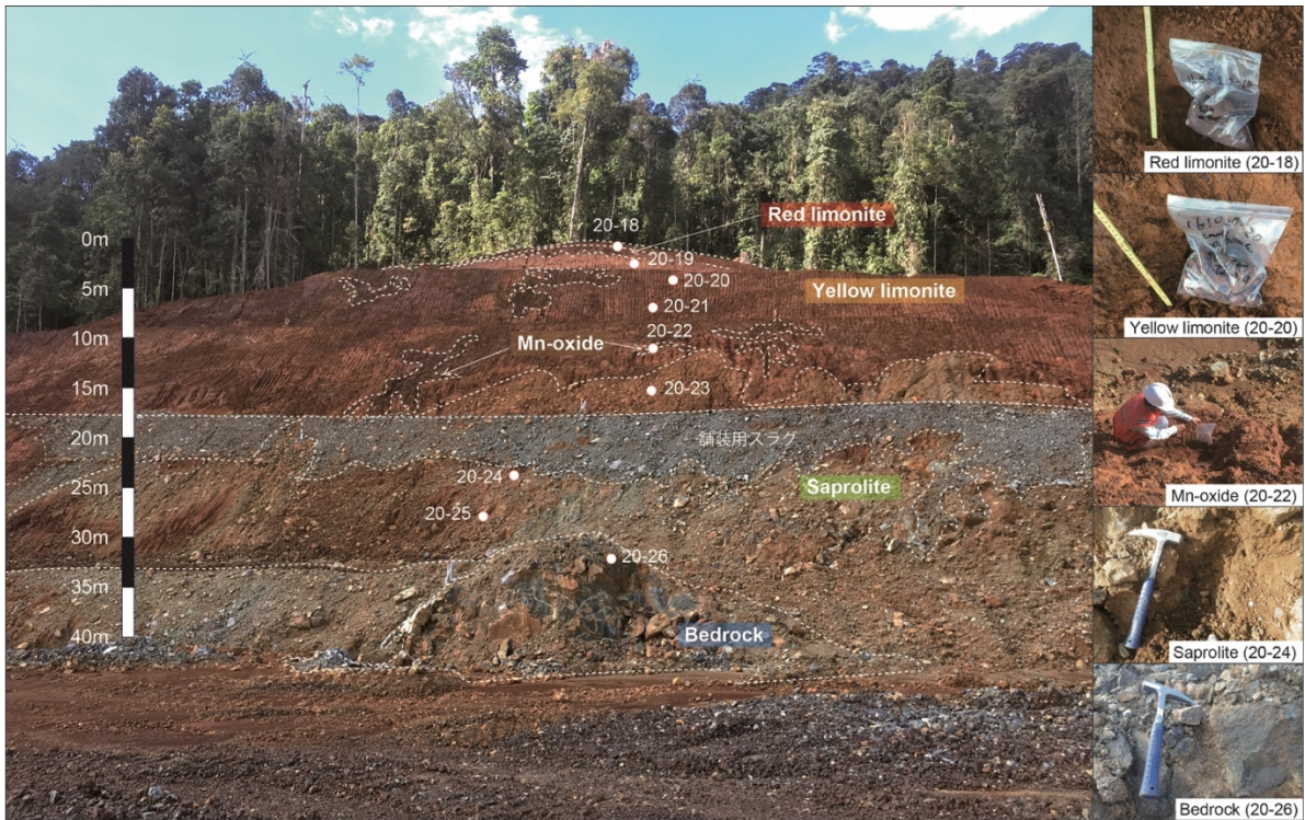
Fig. 4.7 Petea Hill の断面の様子と試料採取位置および各層の代表的な試料写真.
