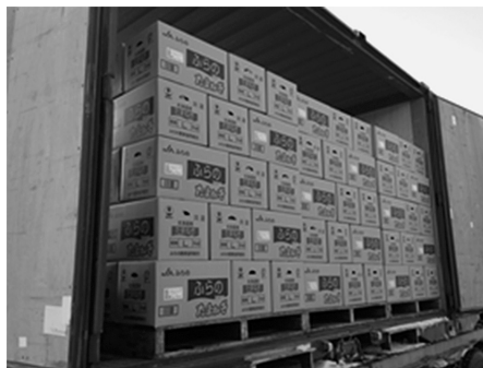
写真2 パレット化でのコンテナ輸送
