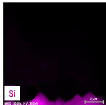
図 6.12 Sn 添加 Cu-P 合金電極の HAADF-STEM 像及びマッピング結果 (Sn-40 wt%組成、焼成温度は 620 °C、分析箇所②)
