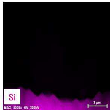
図 6.11 Sn 添加 Cu-P 合金電極の HAADF-STEM 像及びマッピング結果 (Sn-40 wt%組成、焼成温度は 620 °C、分析箇所①)
