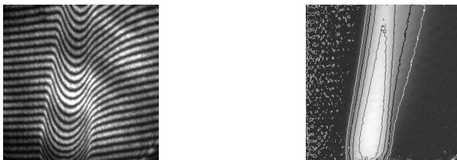
図 3.2: 良条件の実測干渉画像 i_{\text{seed}}(\mathbf{r}) とルールベース手法による抽出位相 \phi_{\text{seed}}(\mathbf{r}) の例． \phi_{\text{seed}}(\mathbf{r}) の等高線間隔は 2\pi [rad] ．
