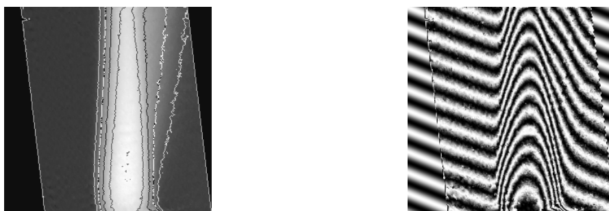
図 3.4: 変形処理により不自然な位相の段差が生じた位相変化像 i_{\text{seed}}(\mathbf{r}) と, i_{\text{seed}}(\mathbf{r}) から生成された干渉画像の例.位相変化像の等高線は 2\pi[\text{rad}] ごと.
