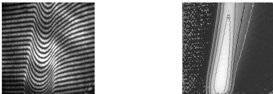
図 2.3: 干渉画像と位相変化像の例（位相変化像の等高線は 2\pi [rad]ごと）。
