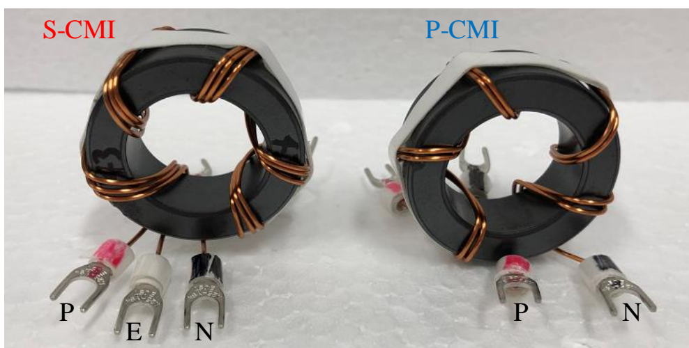
図 6.6. 製作した高周波共通モードインダクタの外観
