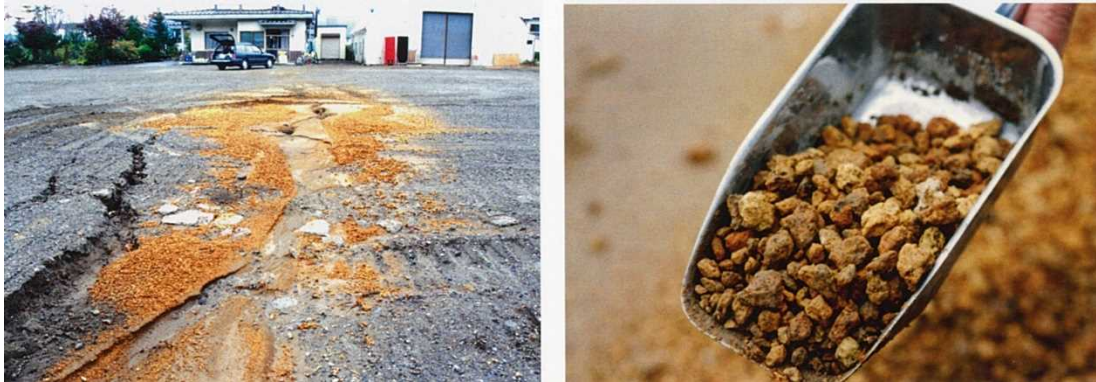
(a) 1994年北海道東方沖地震で液状化した降下軽石（中標津町、摩周降下軽石 Ma-I） 3)
