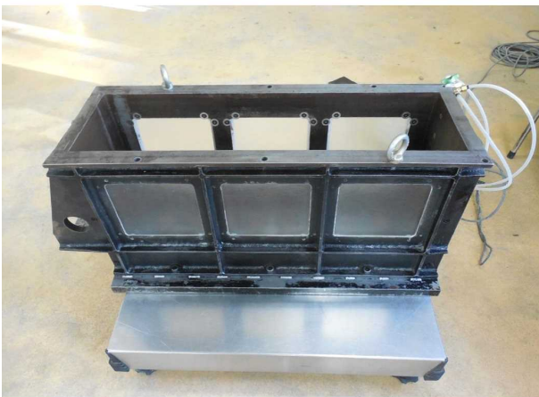
付図 3.1 寒地土木研究所の遠心力载荷装置用動的加振装置で使用される実験土槽と模型の作製状況
