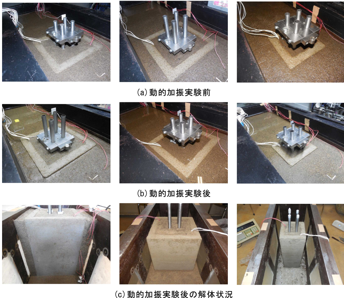
図 5.5 実験前後の周辺地盤状況と実験後の地盤改良壁（左から、対策工 1、対策工 2、対策工 3）
