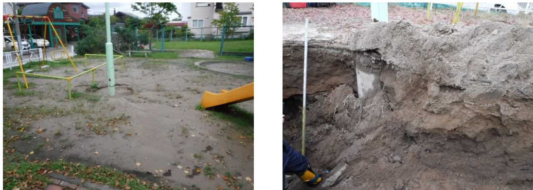
(b) 2003年十勝沖地震、2018年北海道胆振東部地震で液状化した軽石流堆積物 （札幌市清田区美しが丘、支笏軽石流堆積物 SpfI）
