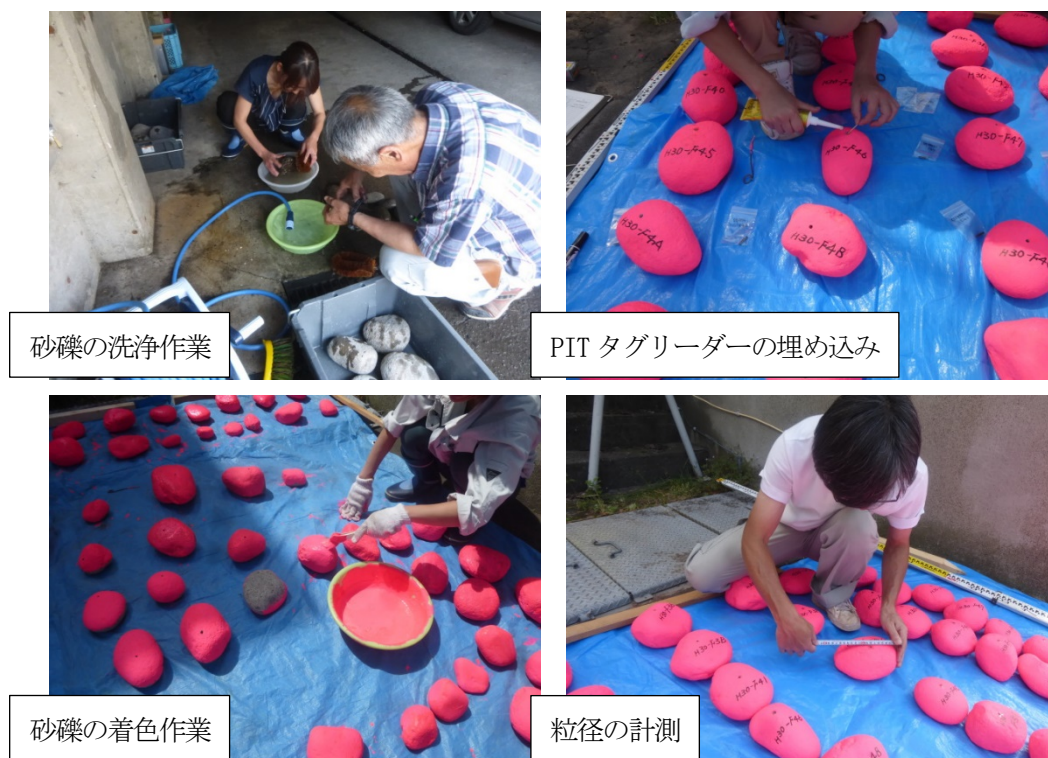
図 4.2 トレーサー材の製作作業状況（粒径 50mm～150mm 程度）
