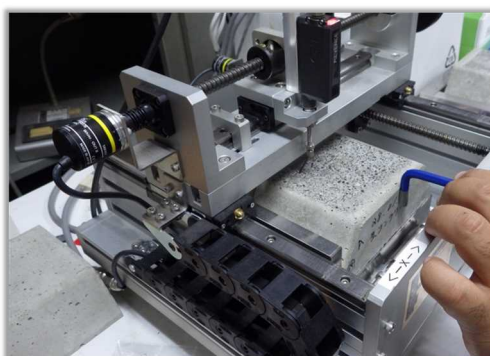
写真-5-3-5 摩耗試験後の凹凸測定状況
