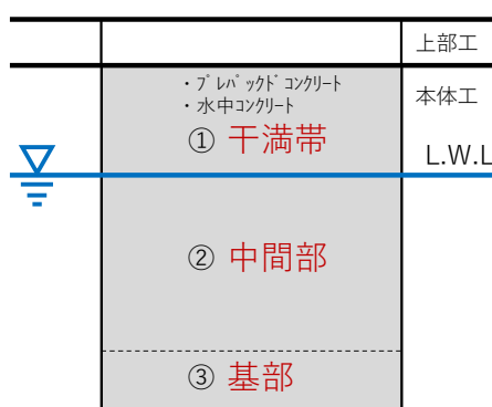
図-4-5-1 防波堤本体工のスパン毎に設定した劣化度マップのエリア
