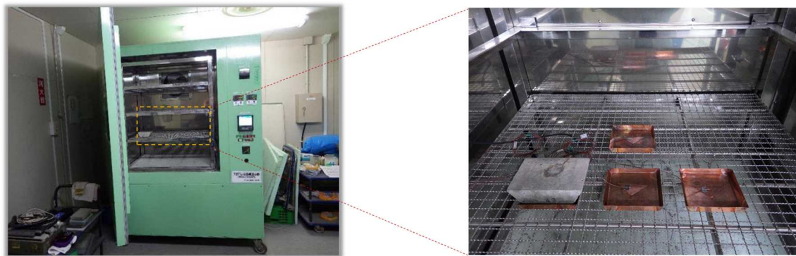
写真-5-3-1 凍結融解試験機の全景とその内部
