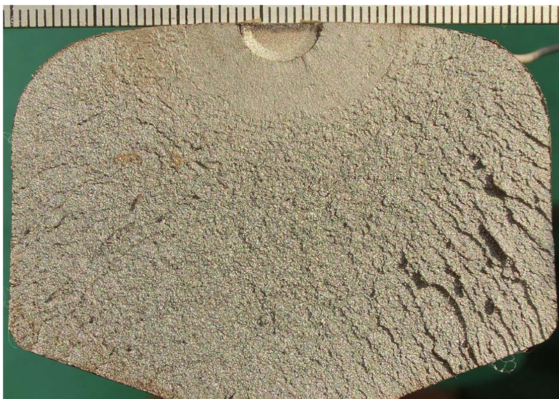
資図 1-3 供試体 No. 3 破面（新品熱処理レール）
