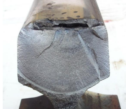
図 1-12 シェリングからの横裂
