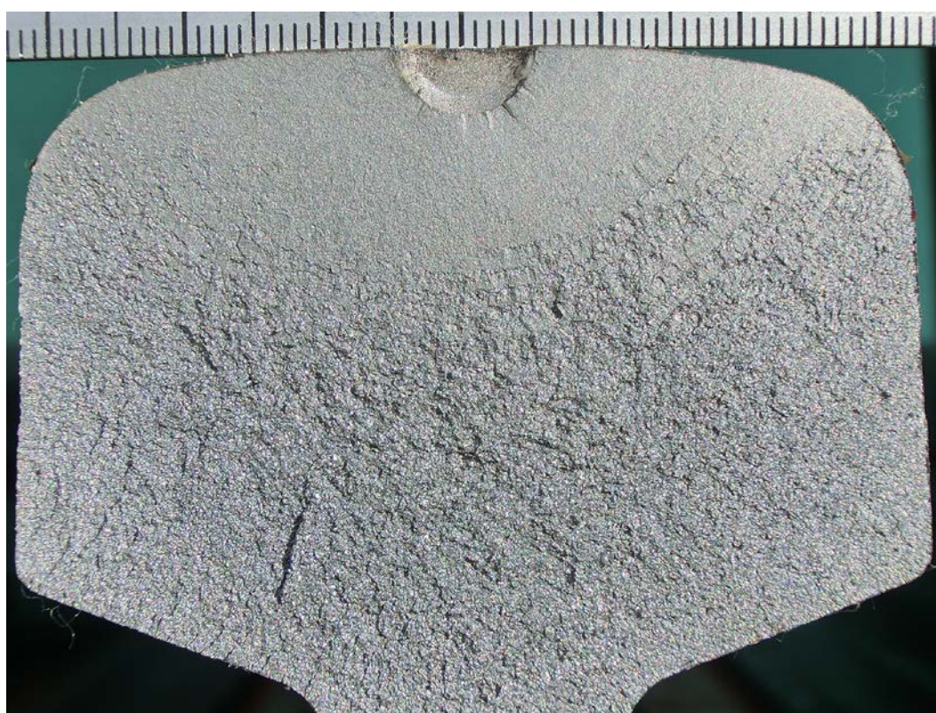
資図 1-4 供試体 No. 4 破面（新品熱処理レール）
