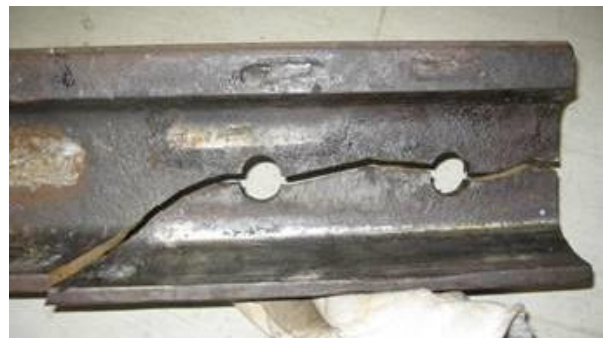
(b) 継目穴からのき裂による折損-2
