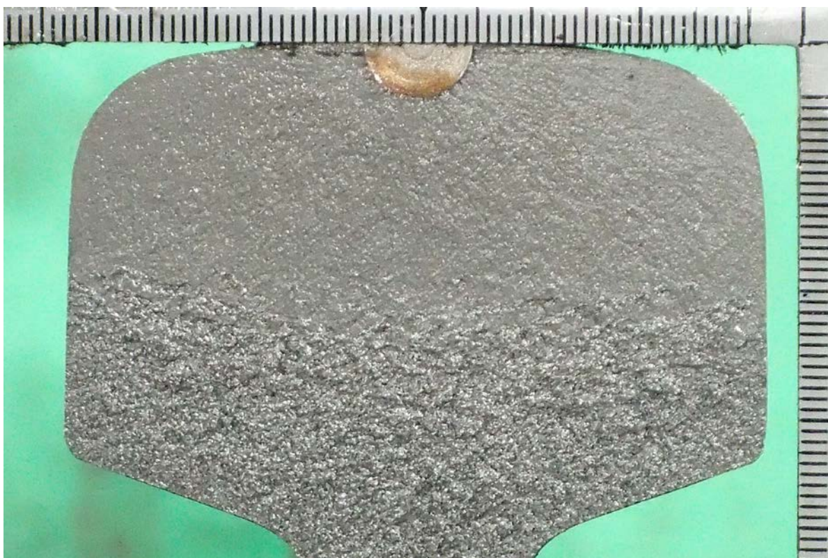
資図 1-11 供試体 No. 11 破面 (新品普通レール(焼きなまし))
