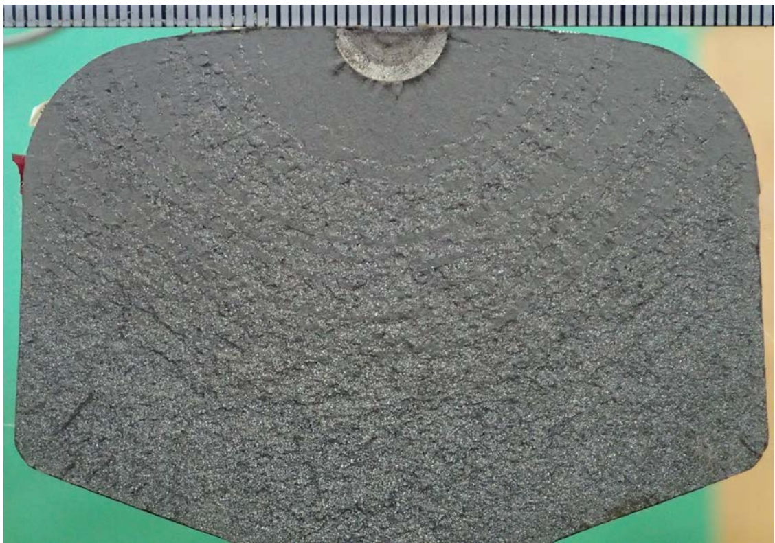
資図 1-2 供試体 No. 2 破面（新品熱処理レール）
