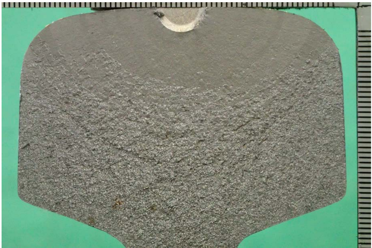
資図 1-8 供試体 No. 8 破面（新品熱処理レール）
