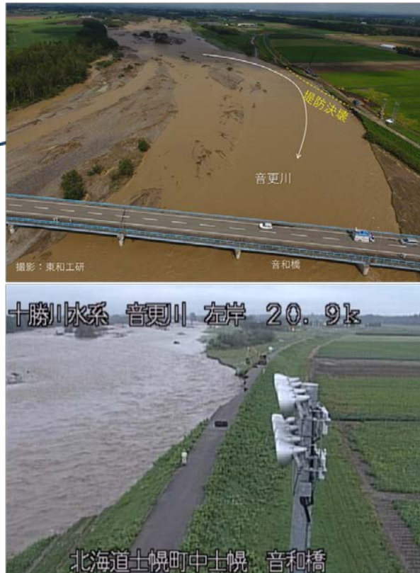
図 2-12 2016 年 8 月洪水による河岸侵食（侵食幅 20m 以上）の発生箇所（開発局提供 28) ）
