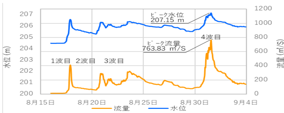
図2-11 2016年8月降雨前後における音更川(士幌観測所)の水位・流量ハイドログラフ(北海道開発局提供, 暫定値)
