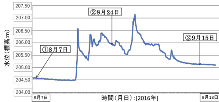
図 3-2 音更川士幌水位観測所水位ハイドログラフ(北海道開発局提供, 暫定値) [2016年8月7日~9月18日, 図中の日付はと図 3-3 に対応]
