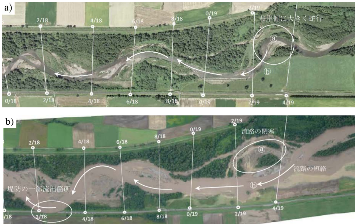
図 2-4 2011 年 9 月洪水による音更川 KP18.0 付近の堤防の一部流失(開発局提供)
