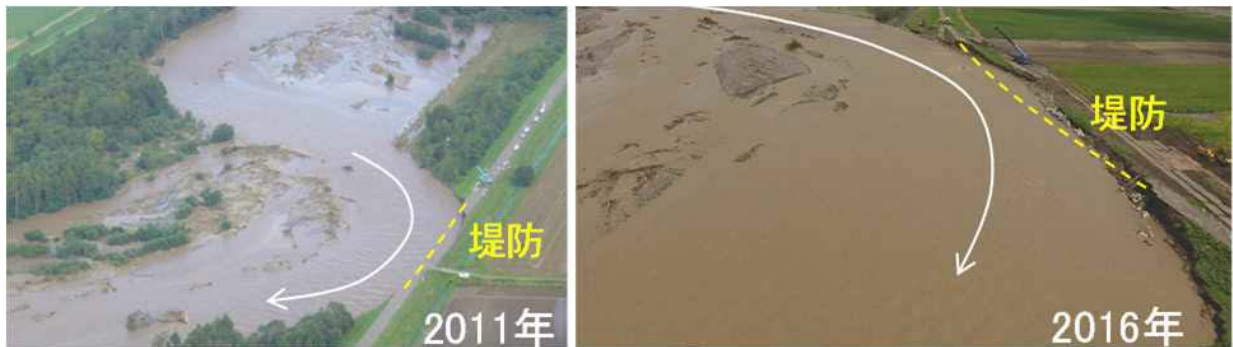
図 5-6 音更川の堤防決壊事例
