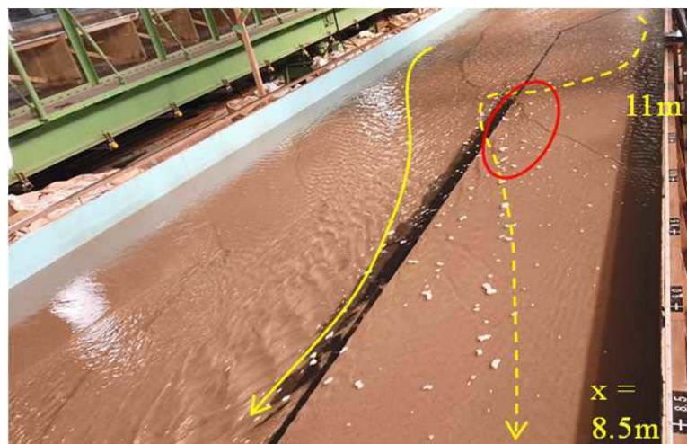
図5-15 最大流量時の流況(Run 4) (赤丸は図5-14と同じ個所を示す)
