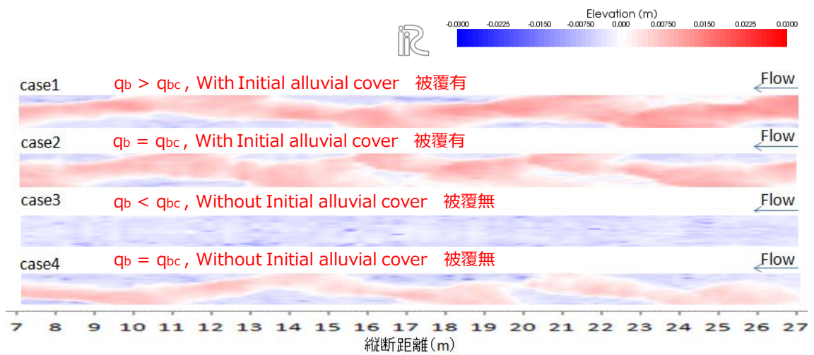
図 3-12 20 時間通水後の河床変動コンター図
