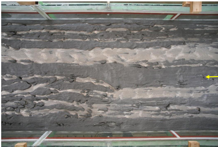
図 3-14 20 時間通水後の case3 の砂礫撤去前河床状況
