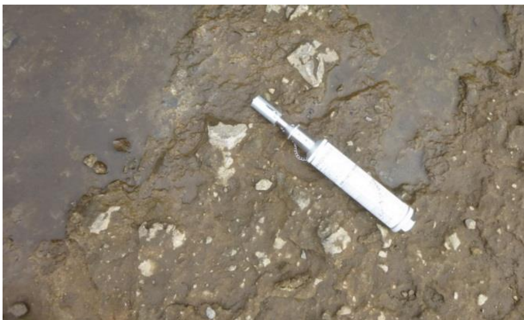
図 4.7 花魁淵上流の八垂別集塊岩と軟岩ペネトロ計
