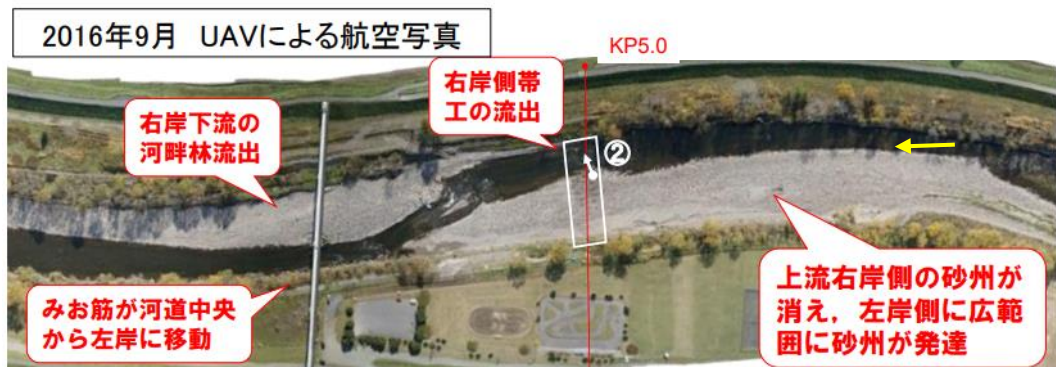
図 3-2 無加川 (KP5.0 付近) の岩盤床上の砂州移動 9)
