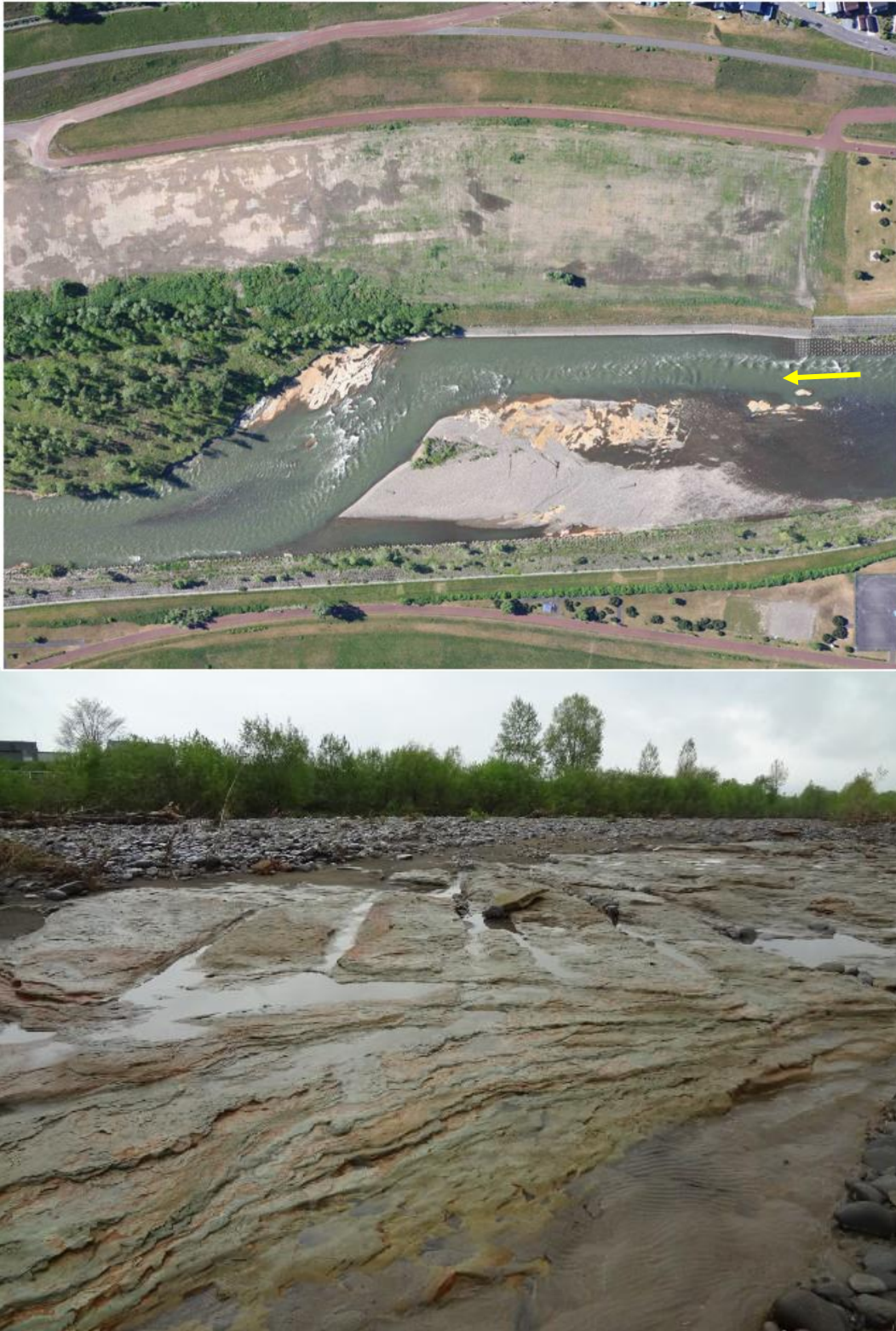
図 3-1 石狩上流 (KP160.5 付近) の砂礫の堆積と岩盤侵食
