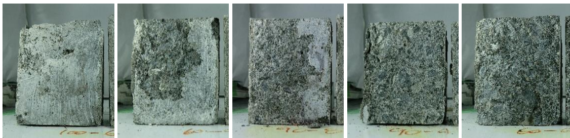
(a) DM 100 (b) DM 90 (c) DM 80 (d) DM 70 (e) DM 60 図 6-12 割裂引張試験による片面吸水凍結融解試験「後」のコンクリート破断性状
