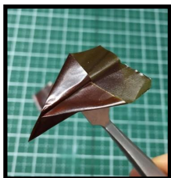
図 2.15. 1 wt% TOCN 添加リグニンフィルムから作製した紙飛行機
