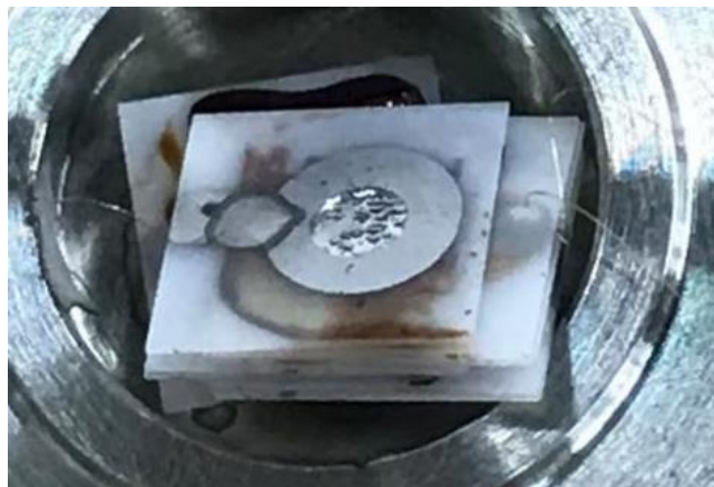
図 3.17 空気雰囲気下での高温試験後の積層素子周辺の写真 金線を軽く引っ張っただけで積層構造が崩壊した
