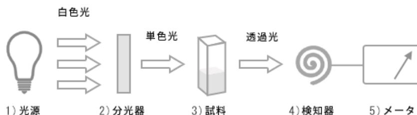
図 A-11. 吸光光度法の測定体系例[A-18]。
