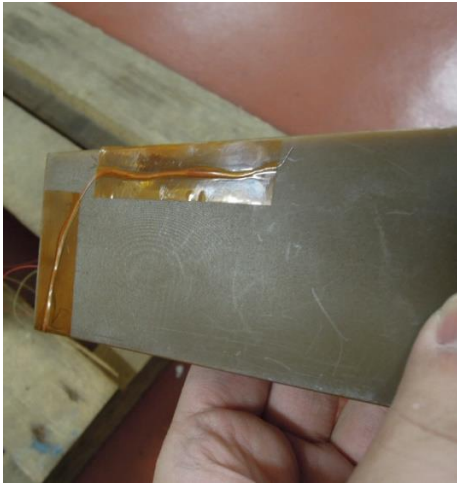
図 3-1. モデレータへの熱電対設置状況。
