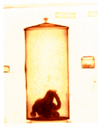
図1-1. 経筒に対するX線と中性子の透過画像[1-7]。
