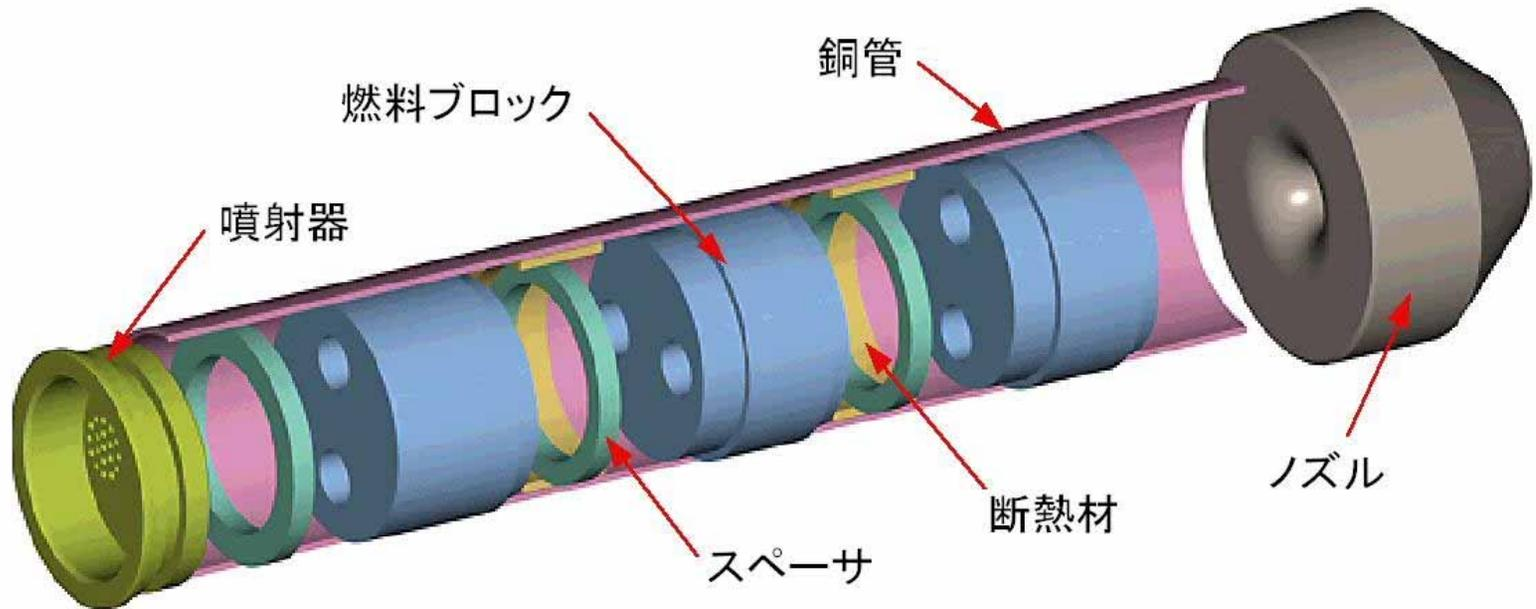
燃焼ガスが固体燃料表面への衝突を順次繰り返すように燃料形状に工夫を加えた、縦列多段衝突噴流 (Cascaded Multistage Impinging-jet, CAMUI)方式を発案。固体ロケット並の小型高推力化に成功 (特願2003-285514)。
