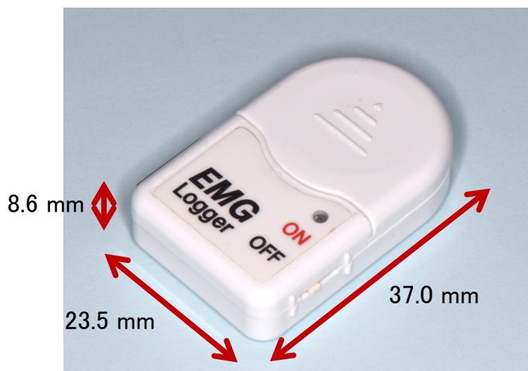
図2 超小型ウェアラブル筋電計
