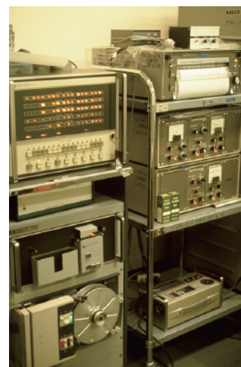
図2 研究に用いたミニコンピュータYHP4100A(左側)と波高分析器や心電図(右側)レジスタの内容やプログラムカウンタがランプで点滅するので動作状況がよくわかった
