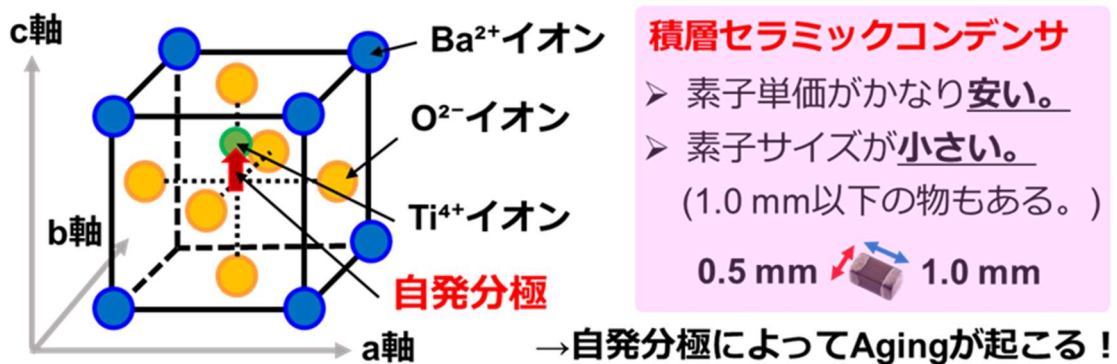
図2 チタン酸バリウムの結晶構造とコンデンサとしての特徴
