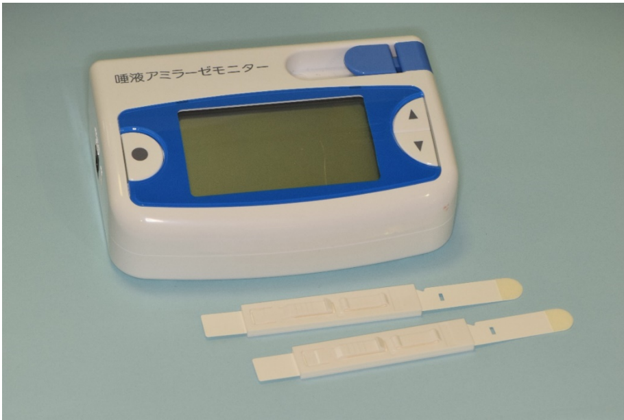
図 3 携帯型 SAA 測定機器・唾液アミラーゼモニター (旧ココロメーター) (ニプロ)
