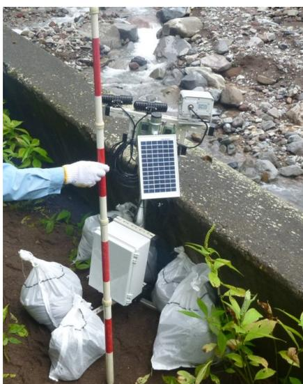
図 2.7 撮影実験用高感度カメラ
