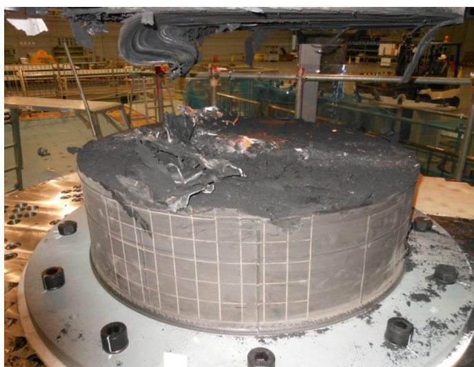
写真 2.2-6 破断後の試験体（下側）
