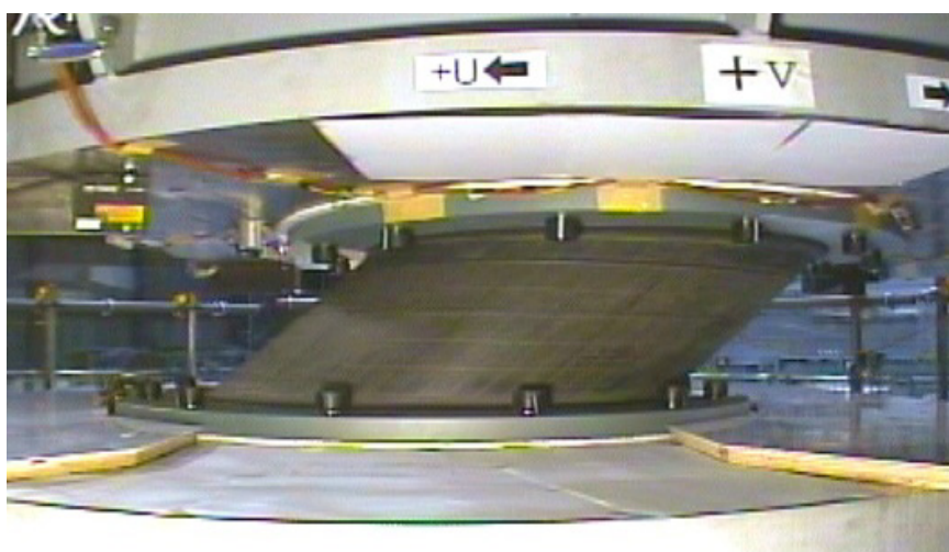
写真 2.2-5 400mm 変形時の試験体
