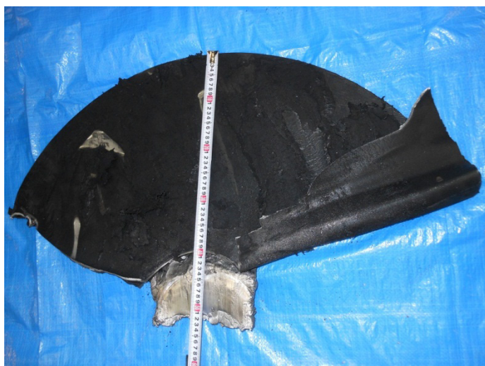
写真 2.2-8 飛散した鋼板と鉛プラグ
