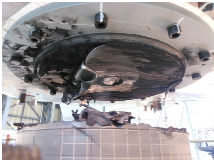
写真 2.2-7 破断後の試験体（上側）
