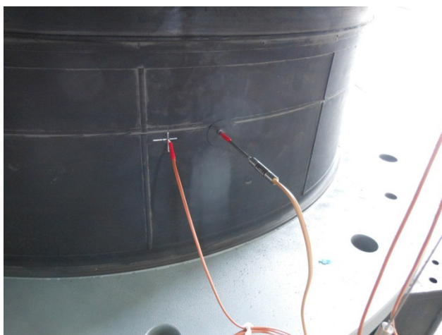
写真 2.2-4 被覆ゴム内部，鉛中央部の熱電対設置状況
