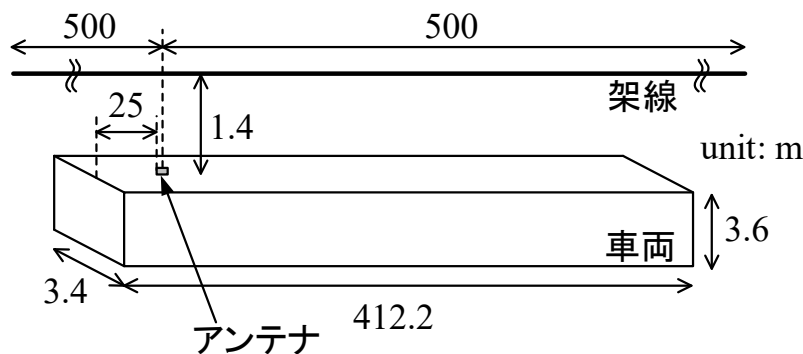
図 5-13 車両搭載状態での準静電磁界解析モデル (Copyright(C)2022 IEICE, [82] 図 10)
