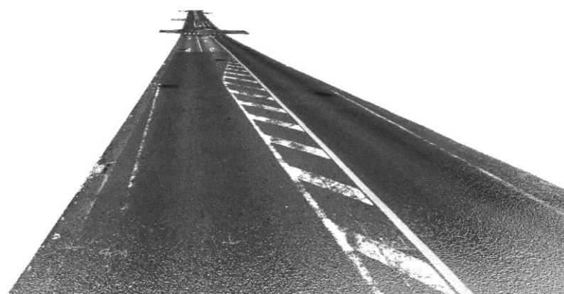
(b) 車道部舗装面のための MMS 点群
