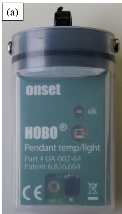
Fig. 3-2. 環境パラメータ測定に用いた計測機材：(a) 照度計 UA-002-64，(b) 濁度計 TR-55。
