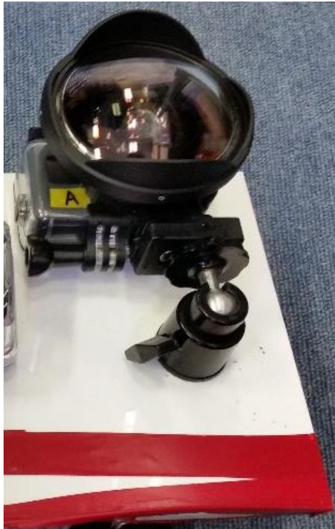
Fig. 1-7 撮影に用いた GoPro HERO6 Black 及びコンバージョンレンズ UFL-G140 SD
