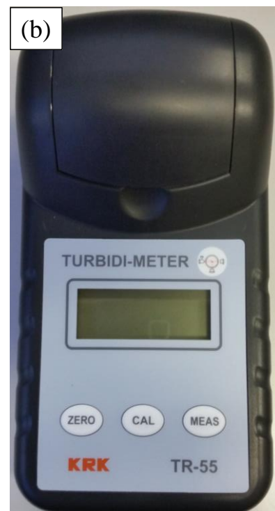
Fig. 3-2. 環境パラメータ測定に用いた計測機材：(a) 照度計 UA-002-64，(b) 濁度計 TR-55。
