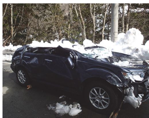
図 3-13 デブリの積雪荷重により破壊された埋没車両（中村ら，2014）
