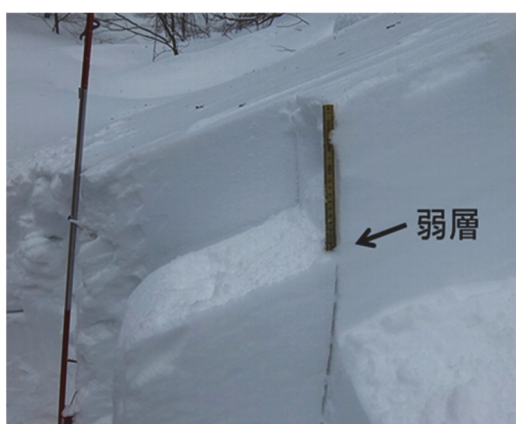
図 1-19 破壊テストで現れた弱層（中村ら，2014）
