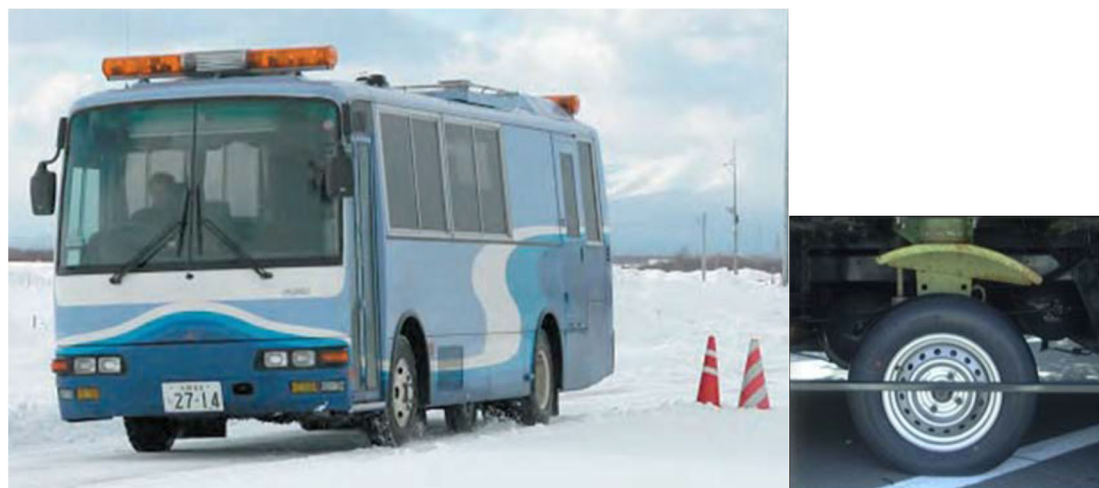
図 1.19 路面すべり測定車（左：測定車，右：測定輪）
