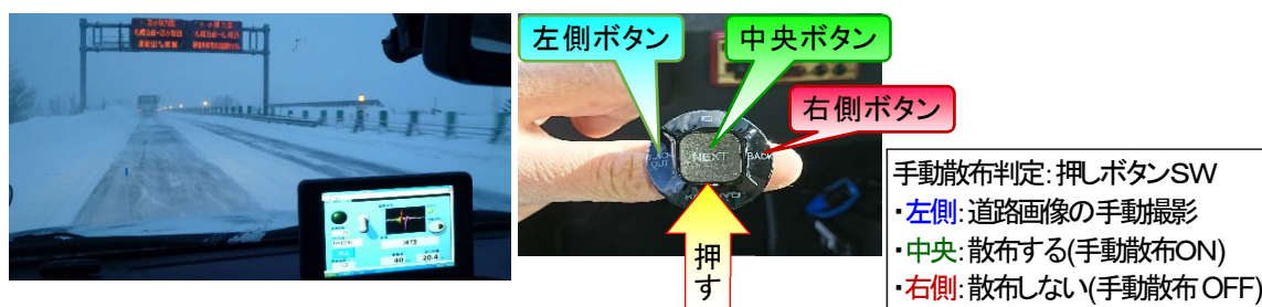
(a) 雪氷巡回車: 散布必要路面で押しボタン SW を押して散布区間データとする
