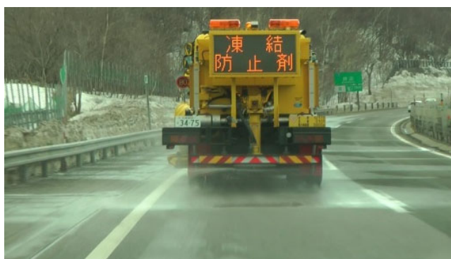
図 4.10 浸み出しにより凍結防止剤散布が必要な区間のみ凍結防止剤自動散布実施状況
