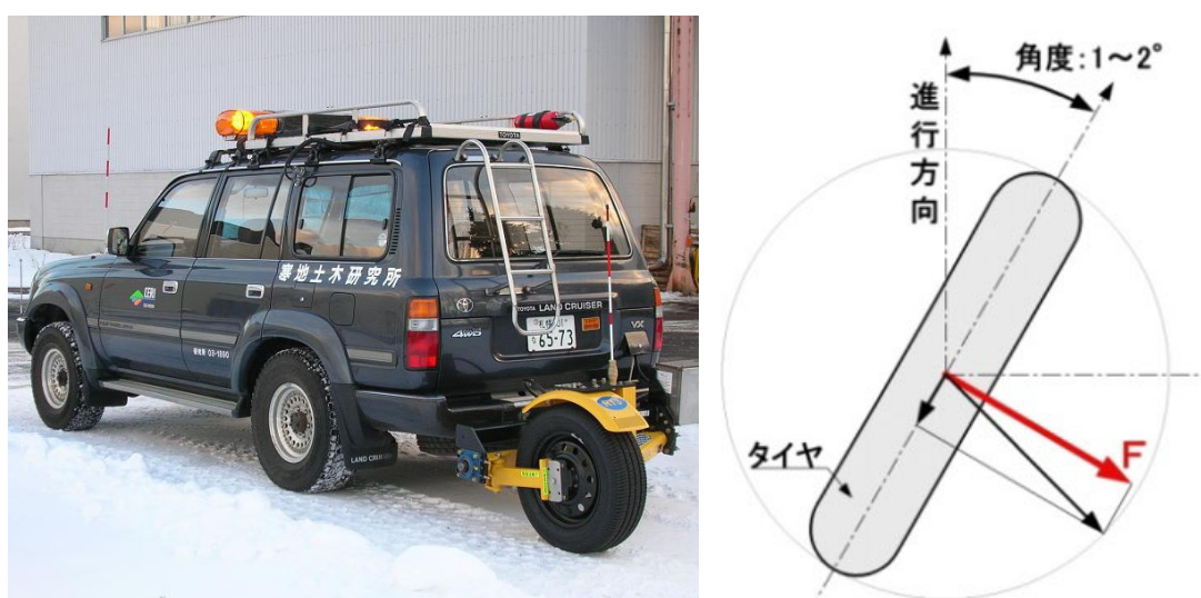
図 1.21 連続路面すべり抵抗値測定装置 (CFT) 外観 (左) と測定概念図 (右)
