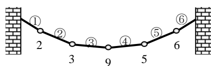
1, 2, ...: 節点番号 ①, ②, ...: 部材番号 図 3-13 吊床版構造物解析モデル
