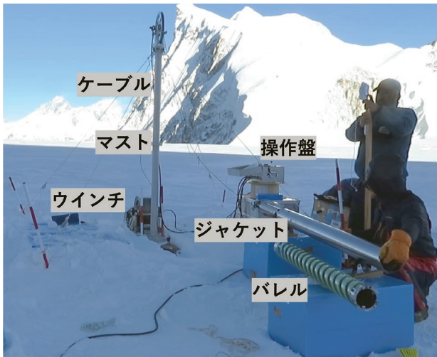
図6: 2019年の観測にて実際に設置された掘削システムの様子。撮影されたのはドリルがスタックした11月5日で、氷から引き出したドリルのジャケットを木槌で叩き、チップを取り出す様子。著者による撮影。
