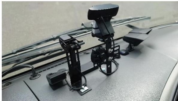
(b) 車両前方に設置したカメラと GNSS 受信機
