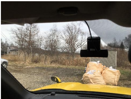
(b) 車両前方に設置したカメラ
