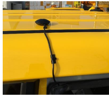
(c) ルーフに設置した GNSS 受信機
