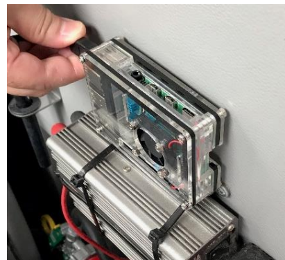
(c) 運転席後方に設置したマイクロコンピュータ
