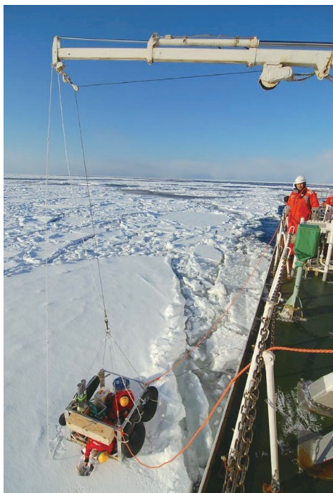
図9：バスケットを用いて海水や積雪のサンプリングをしている様子 Figure 9: A photo, showing the sampling observations of sea ice and snow using a basket.
