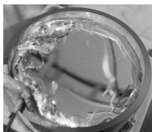
図 3.17 窒素プラズマ照射時における液体ガリウム表面に付着した白い堆積物
