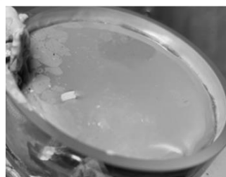
図 3.17 窒素プラズマ照射時における液体ガリウム表面に付着した白い堆積物
