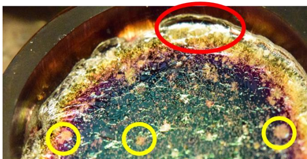
図 3.20 銅容器を用いた場合に観測されたガリウム表面に形成されたガリウム合金
