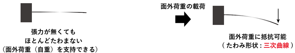
図-4.3.1 幾何剛性の例：糸と針金の場合
