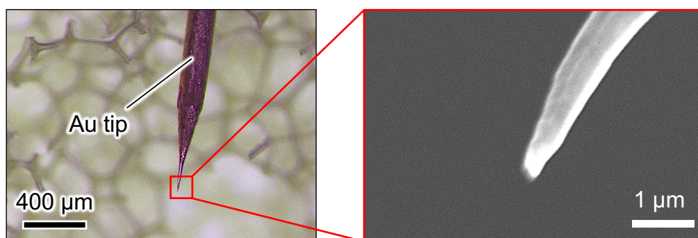
図 3.18 上部電極として用いた Au 探針先端の光学顕微鏡像及び走査電子顕微鏡像.
