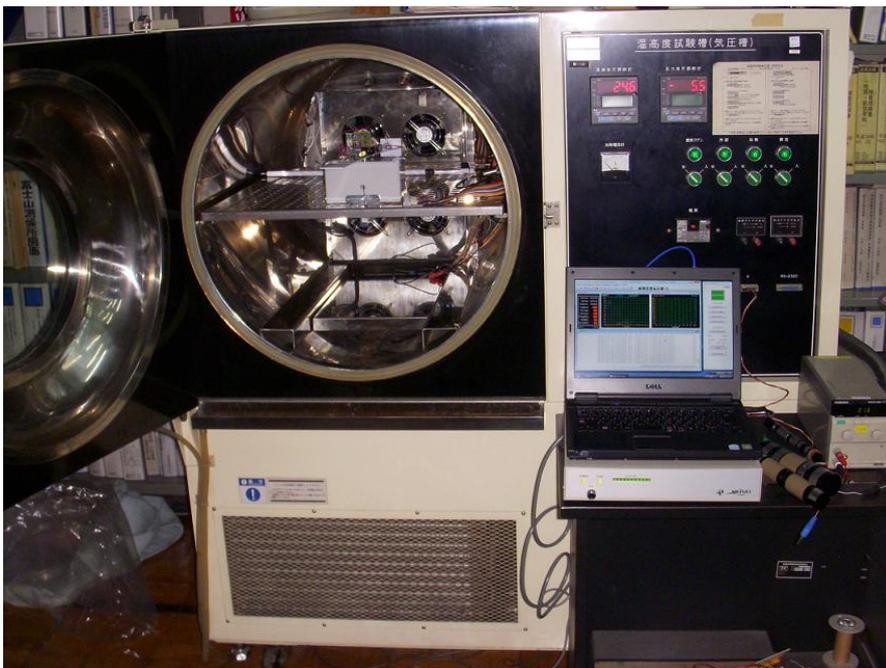
図 5.11 風速計測実験の様子(上:筒内のサーミスタの取り付け、中:回転台、下:気圧槽内での実験)
