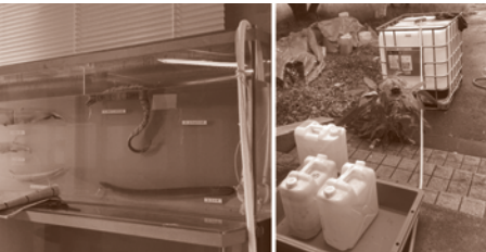
家庭用のバスポンプに約20メートルのホースを接続し、ホルマリンを屋外の廃液タンクへ排出しました。処理には時間を要しましたが、作業者が室内に長時間とどまる必要がなくなり、ホルマリンへの曝露リスクを大幅に軽減することができました。
