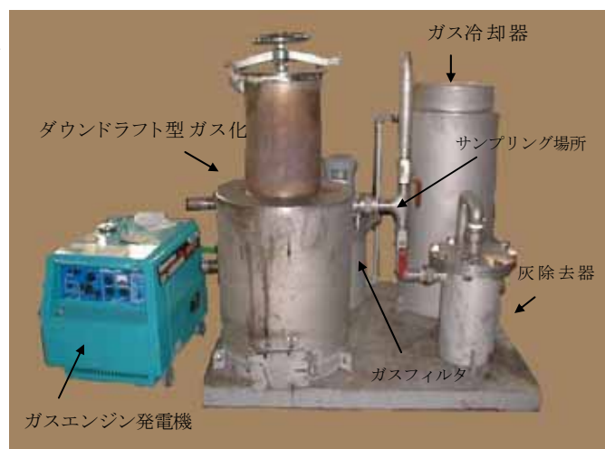
図2 ガス化発電装置概観図
