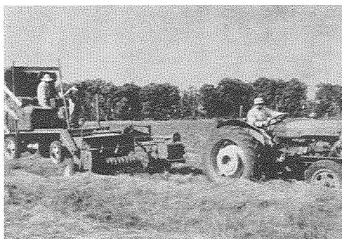
13. ベーラーにトレーラーを直結しての作業状況 (第1畜産部での37年度作業)
