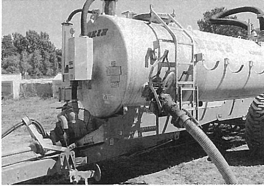
図11. 消化液タンクからスラリータンカーへの消化液移送時の様子
