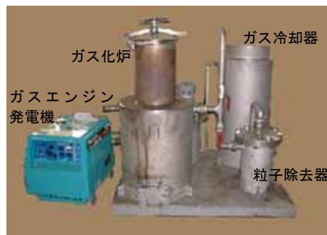
図3 バイオマスガス化—内燃エンジン CHP システム実験装置の外観
