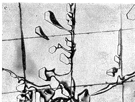
写真1. 樹枝状結晶. その1 (-15°C, 温度勾配 0.3°C/cm) 矢印は温度勾配の方向を示す. a) はじめ b) 24時間後 c) 48時間後
