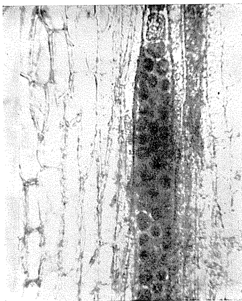
第 10 圖 同拡大。髓線のみが変色している。× 350
