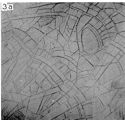
3a. 5% ゼラチン溶液. -25^{\circ}\text{C} 凍結後 -196^{\circ}\text{C} まで冷却. 凍結状態. 普通光. \times 50 直線又は曲線からなる亀裂が縦横に走り網目 を作る
