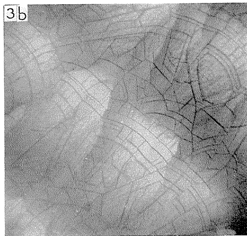
3b. a と同一視野. 偏光. \times 50 亀裂のパターンが氷晶の periodicity とある 関連を示す
