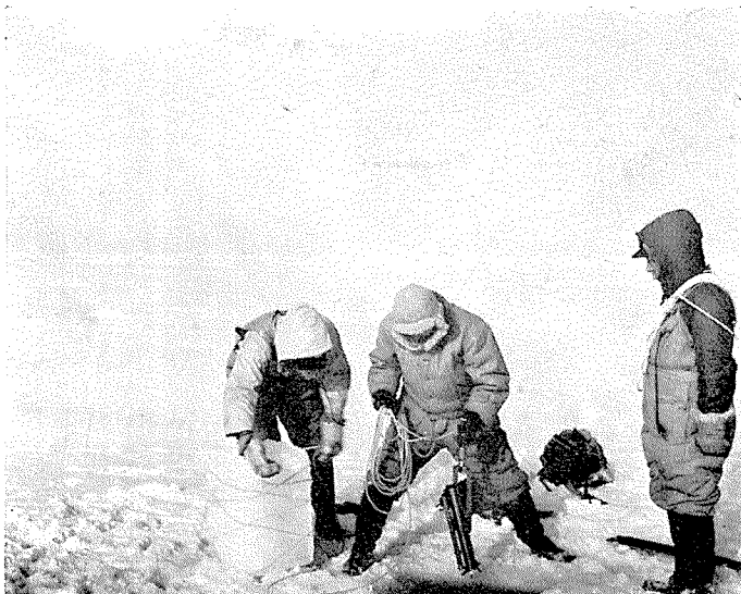
寫真 20 海氷下の採水測温 (1945, II, 網走)
