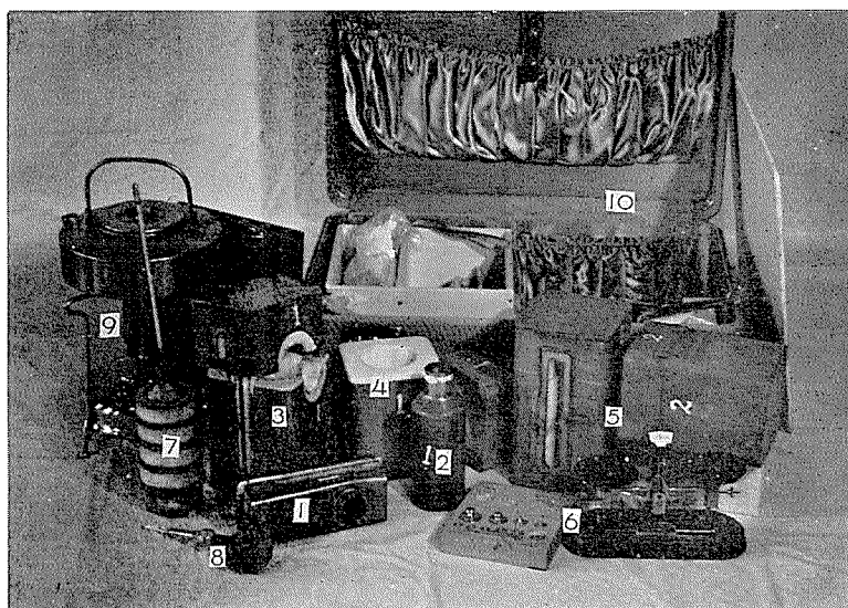
第 2 図 結合熱量計一式。熱量計は 2 組ある。1-容器 A, 2-容器 B, 3-容器 A の断熱壁, 4-容器 B の断熱壁, 5-結合された容器 AB (他の一組), 6-薬局用天秤と分銅 (0.1 gr まではかれる), 7-湯ます, 8-スポイト, 9-登山用の湯わかしとこんろ, 10-手さげかばん。
