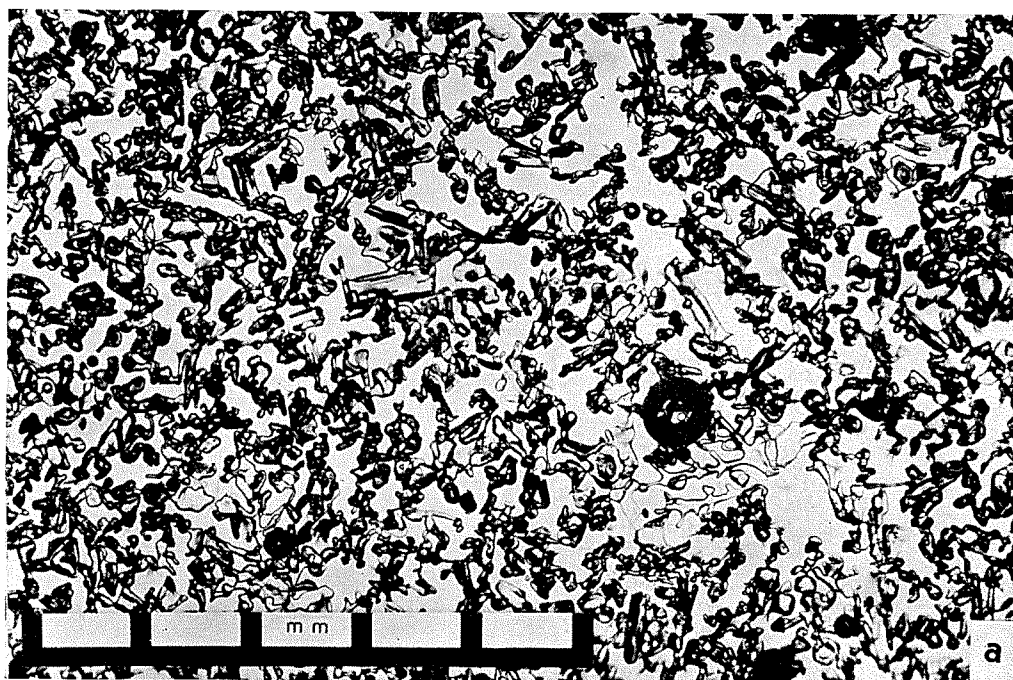
a J17 層の 1 日後の水平薄片. 密度 0.12. ものさしの全長が 5 mm.
