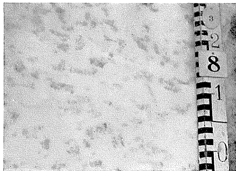
第 10 図 融雪最盛期に, しまりゆき層にできた水みち。写真のうすぐらい斑点がそれである。
