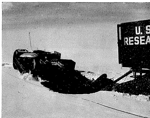
第10図 クレバス—(iii)型に前輪が落ちこんだ Rolie Trailer (APT, 1962年2月3日)
