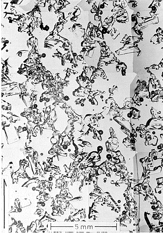
7 ブロック下部, 試料番号 No. 13, 42 日目, 温度勾配 0.31^{\circ}\text{C}/\text{cm}
